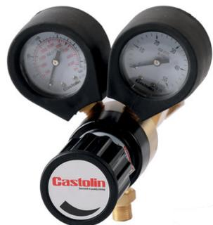
Les manodétendeurs TYPHOON sont du type simple détente, à clapet placé dans la haute pression. Ils sont conçus pour être utilisés avec les bouteilles de gaz industriels : oxygène, acétylène, pour équiper les postes de soudage flamme portables "CASTOFLAM" et argon, mélanges argon/Co2, pour les postes de soudage TIG, MIG/MAG.
