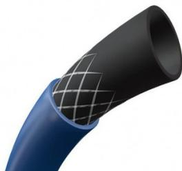
Tuyau d'une exceptionnelle souplesse pour l'alimentation en air comprimé. Conception tri-couche, en PVC extra-souple, avec renforcement en fibre polyester haute ténacité. Rayon de courbure : 22,5 mm
