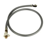
Pression maximale d?utilisation : 37 mbar. Robinet avec obturateur automatique intégré. Tuyau flexible inox annelé renforcé par une tresse en fil d?acier inoxydable, équipé d?1 joint. Sortie : écrou prisonnier tournant femelle G 1/2?? avec bouchon. Classe de température : - 5°C / + 60°C.
