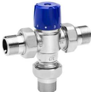
Mélangeur thermostatique en T réglable pour installations sanitaires. Corps chromé en alliage anti-dézinification (taille 1/2" et 3/4"). Corps en laiton chromé (taille 1" - 1"1/4 - 1"1/2 - 2"). Ressorts en acier inoxydable. Joints d'étanchéité en élastomère. Raccords filetés UNI-EN-ISO 228. Pression dynamique max 5 Bars. Pression statique max 10 bar. Température max. d'entrée 85 °C. Intervalle de réglage +30 ÷ +65 °C. Précision : ± 2 °C
