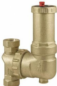
Séparateur d'air orientable montage vertical, horizontal, oblique. Garantie l'efficacité de l'installation avec une haute capacité de décharge. Corps en laiton. Flotteur à levier en résine polypropylène. Cartouche en inox aisi 302 ressort en inox aisi 302. Destiné à eau et eau +glycol 30%. Pression d'utilisation et de décharge maxi : 10 bars.
