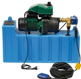
Ensemble complet et prémonté. En cas de manque d'eau dans la cuve enterrée, commute automatiquement sur l'eau de ville grâce à l'électrovanne. Comprend un réservoir disconnecteur entièrement équipé 25L, un Active Jetcom 102 M, un électrovanne 3 voies, un flotteur avec contrepois (longueur 20 mètres). Installation au sol ou murale.
