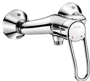
Cartouche céramique Ø 40 et butée de température maximale préréglée. Débit limité à 8 l/min à 3 bar. Commande par manette ajourée. Sortie basse M1/2" avec clapet antiretour intégré. Corps en laiton chromé. Mitigeur livré avec raccords STOP/PURGE M1/2" M3/4" adaptés aux contraintes des hôpitaux.
