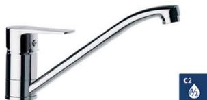
Débit à 3 bar: 12 l/min. Niveau sonore à 3 bar < 20 dB. Système d'économie d'eau (S2-C2) par ouverture de la manette en deux temps. Système Thermostop Block de limitation de la température maximale de l'eau chaude. Chromé laiton : épaisseur du nickel : 15 microns, épaisseur du chrome : 0,3 microns. Résiste aux pressions statiques ? 10 bar et coup de bélier de 25 bar.
