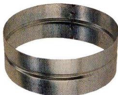
Ce raccord mâle de diamètre 160mm ou 200mm, permet de raccorder les conduits rigides circulaires des réseaux aérauliques. En acier galvanisé standard et facile à monter, par simple emboîtement, il participe à la bonne étanchéité des réseaux VMC collective et tertiaire.
