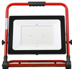
3m de câble H05RNF 3G1, très grande luminosité, économie d'énergie. Led de type SM avec grande durée de vie : 40 000 H. Faible dégagement de chaleur. Tête en IP65 et fiche IP44. Vitre : non démontable. Possibilité de l'adapter sur un pied télescopique.
