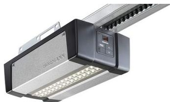
Le moteur de porte de garage SupraMatic E est adapté aux portails d'une largeur maximale de 5500 mm et d'une surface de porte jusqu'à max. 13,75 m<sup>2</sup>. Il est adapté aux portails avec portes coulissantes et aux portails en bois. Le moteur est livré avec un rail, un émetteur manuel HSE 4 et un câble de raccordement. Caractéristiques techniques : Faible consommation d'énergie : moins de 1 W | Force de traction et de pression : 650 N | Vitesse d'ouverture max. 25 cm/s.
