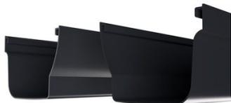
Gouttière avec profil réversible : une face plane et une face galbée, des lignes fluides et épurées pour souligner d'un trait esthétique l'entourage de vos toitures. Grâce à sa section utile de 119 cm<sup>2</sup> et des naissances en 80 et 100 mm, la gouttière LA REVERSIBLE® accepte jusqu'à 100 m<sup>2</sup> de surface de toiture en plan par descente (DTU 60.11) Les crochets de la gouttière LA REVERSIBLE® sont adaptés aux 2 esthétiques et sont invisibles et clipables.
