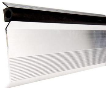
La bande de solin de type SP/F assure l'étanchéité de la couverture. Munie d'un joint EPDM en caoutchouc, elle permet de raccorder et de protéger un relevé d'étanchéité. Elle s'installe au droit de pénétrations continues ou discontinues, d'émergences et de reliefs. Elle peut être appliquée sur un ouvrage comportant un relief en béton, ou sur une maçonnerie d'élément plein ou creux enduit.
