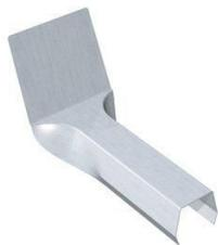
Le couvre-joint de tête est un élément employé dans les systèmes de couverture à joint debout, pour des toitures de 5 % de pente ou plus. Il garantit l'étanchéité du relevé du bac de zinc au faitage. Il dispose de languettes permettant une fixation facile sur le joint debout.
