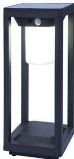
Matériaux : Aluminium, diffuseur en polycarbonate. Température de couleur : 3000°K. Faisceau : 120°. Flux lumineux : 300 Lm. Puissance panneau solaire : 2,1W. Batterie : Li-ion 2200 mAh/3,7V (remplaçable). Détecteur de mouvements : 2 à 5 mètres, temporisation 30 secondes, détection infrarouge angle 120°. Indices de protection : IP55 / IK07. Alimentation : panneau solaire. 100% autonome détecteur crépusculaire
