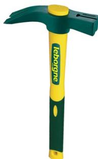
Griffes et angles de la surface de frappe arrondis. Manche ergonomique tri-matière Novamax® haute résistance avec pare-faux-coup acier. Emmanchement douille rase. Acier au Carbone forgé, trempé et revenu. Aimant porte-clou pour pointer d'une main sans tenir le clou. Surfaces de frappe latérales pour travailler dans les espaces réduit.
