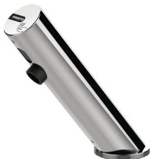
Robinet sur plage pour lavabo PRESTO LINEA. Déclenchement électronique sans contact. Débit 3l/min. Alimentation pile. Raccordement F3/8". Finition chromée. Livré avec robinet d'arrêt.
