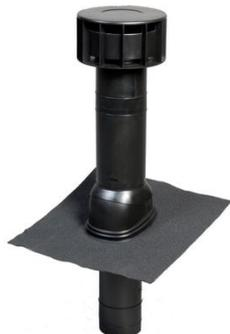
Terminal de ventilation avec extracteur statique pour l'évacuation des gaz de fermentation issu d'une fosse septique toutes eaux. Sa conception utilise la force de vent pour créer une dépression dans le conduit et favoriser ainsi l'extraction des gaz. Kit complet: terminal Multivent, solin d'étanchéité Ubiflex®, collier de serrage et adaptateur multidiam. Installation simple et étanche grâce au solin d'étanchéité Ubiflex®. Conforme au DTU 64.1. Pente minimum: 25°. Pente maximum: 45°.
