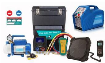
Servante. Manifold électronique avec jeu de flexibles 150 cm. Pompe à vide. Balance électronique. Détecteur de fuite de fluides frigorigènes.
