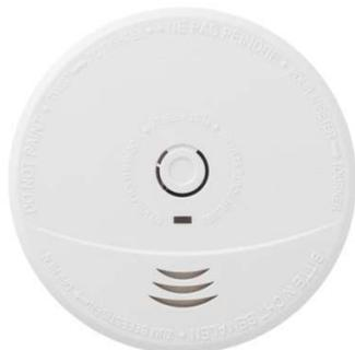
Détecteur de fumée avec capteur optique. Pile 9 V autonomie 5 ans et remplaçable. Alarme sonore puissante 85 dB à 3 m. Signal sonore de pile faible. Certifié CE EN 14604 : 2005+ AC 2008 et NF DAAF. Livré avec pile et vis de fixation.
