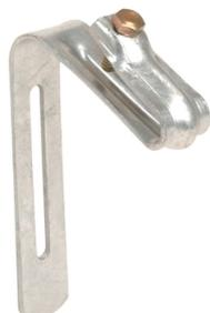
Accessoire métallique permettant de fixer la gouttière sur un élément de toiture par vissage. Fixation sur le sommet de la tuile, le canal d'écoulement reste ainsi parfaitement dégagé. Feuillard de 25 x 2.5 mm à haute résistance élastique.
