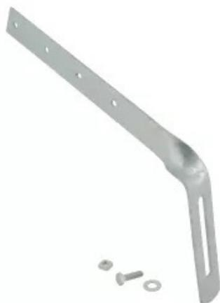
Accessoire métallique permettant de fixer l'ensemble des gouttières Nicoll sur la face latérale des chevrons. Réglage de la pente sur une hauteur de 6 cm.
