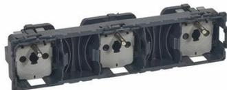
Prise de courant triple précâblée Céliane 3x2P+T 16A 250V - A associer à un support universel Batibox, un enjoliveur et une plaque Céliane, équipée de bornes automatiques avec repérage couleur permettant la connexion rapide sans outil. Se monte sur support référence 080253 avec plaque 3 postes, les éclips de protection enfant de cette prise renforcent la sécurité dans la maison en permettant d'obturer le contact électrique en l'absence de fiche.
