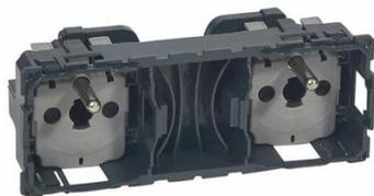
Prise de courant double précâblée Céliane 2x2P+T 16A 250V, équipée de bornes automatiques avec repérage couleur permettant la connexion rapide sans outil. Se monte sur support référence 080252 avec plaque 2 postes, les éclips de protection enfant de cette prise renforcent la sécurité dans la maison en permettant d'obturer le contact électrique en l'absence de fiche. A associer à un support universel Batibox, un enjoliveur et une plaque Céliane.
