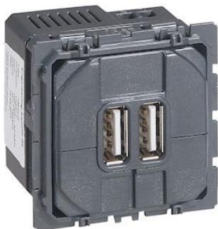
Chargeur 2 USB Type-A 2,4A - 12W Céliane - A associer à un support universel Batibox et une plaque Céliane. Consommation en veille inférieure à 0,07W classe II TBT, les 2 sorties USB en 1 poste libèrent un puit de prise et favorise le gain de place.
