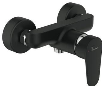
Mitigeur douche D2539U4 Kheops New noir mat Porcher. Cartouche diamètre 38 mm à disque céramique avec limiteur de température intégré, entraxe 150 mm.
