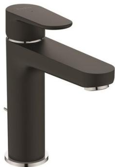
Mitigeur lavabo D2538U4 Kheops New noir mat, avec tirette et vidage polypropylène Porcher. Bec fixe, cartouche diamètre 28 mm à disque céramique avec limiteur de température intégré, aérateur avec limiteur de débit max 5L/min, système de fixation rapide Easy-Fix, hauteur sous aérateur 122 mm, projection 125 mm.
