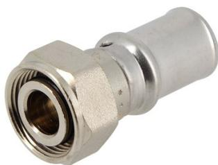
Résistance à la corrosion ainsi qu'aux variations de température et de pression, étanchéité absolue entre la douille et la couche intérieure du tube Fluxo®. Connexion à sertir d'un côté et à visser, de l'autre, grâce à un écrou tournant (écrou libre / prisonnier) en M22 (Spécifique chauffage). Permet de démonter la connexion de manière aisée.
