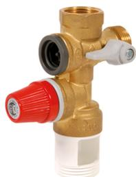
Protège les chauffe-eau jusqu'à une puissance de 10 kW. Corps, vanne à sphère et clapet anti-retour en laiton, sans chrome. Pression de tarage de la soupape de sécurité: 7 bar. Agrée NF. Pose d'un entonnoir siphon obligatoire.
