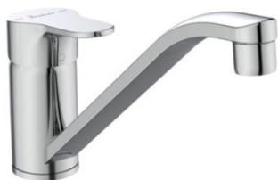
Mitigeur évier monotrou Olyos chrome. Bec profilé orientable avec aérateur intégré. Plaque de renfort pour évier inox. Cartouche Firmaflow® Ø 38 mm à 2 disques céramique, avec limiteur de température intégré et limiteur de débit 50 % déverrouillable. Flexibles anti-torsion PEX 3/8" - 350 mm.
