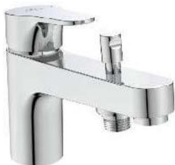
Mitigeur bain-douche monotrou Olyos chrome. Bec long avec aérateur intégré. Inverseur à retour automatique tout métal. Sortie de douche 1/2" par le dessous avec clapets anti-retour intégrés. Cartouche Firmaflow® Ø 38 mm à 2 disques céramique, avec limiteur de température intégré et limiteur de débit 50 % déverrouillable. Flexibles anti-torsion PEX 3/8" - 350 mm
