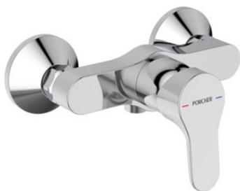
Mitigeur douche mural. Sortie de douche ½" par le dessous avec clapets anti-retour intégrés. Cartouche Firmaflow® Ø 38 mm à 2 disques céramique, avec limiteur de température intégré et limiteur de débit 50 % déverrouillable. Rosaces métal coniques. Raccords muraux
