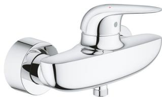
Montage mural apparent. Levier plein en métal. GROHE SilkMove Cartouche en céramique 35 mm. Limiteur de température. GROHE Brilliance Longue Durée. Limiteur de débit ajustable. Sortie douche 1/2" avec clapet anti-retour intégré. Raccords S à rosaces. Rosaces métalliques. Protégé contre les retours d'eau.
