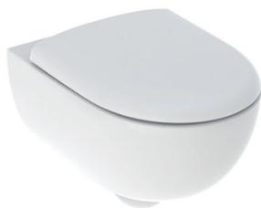
Convient pour un réservoir à encastrer. Robuste, il est en céramique. Sa cuvette Rimfree sans bride assure une évacuation efficace et réduit l'entretien nécessaire. Pratique, la fermeture de l'abattant se fait au ralenti. Les charnières déclinables sont en laiton chromé. Facile à fixer grâce à sa fixation murale Geberit type EFF3, celle-ci est cachée. Caréné, les trous de fixation ne sont pas visible.
