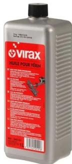
Huile minérale hydraulique hautement raffinée, indispensable au bon fonctionnement des cintreuses hydrauliques Virax (réf. 2402/2408). Très fort pouvoir de lubrification, anti-oxydation, anti-corrosion et anti-usure. Densité à 20°C : 0,87 à 0,89. Viscosité à 40°C : 22 mm<sup>2</sup>/s. Écoulement limite : - 42°C.
