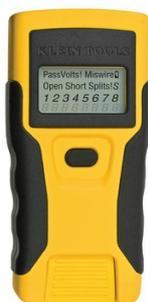
Test de continuité de connexion de câblage informatique à paires torsadées (RJ45)
