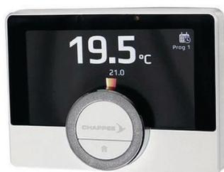
Appareil d'ambiance avec écran rétroéclairé couleur avec menu déroulant et texte clair. Gestion à distance du chauffage par le biais de l'application gratuite eMO Life. Choix du mode de fonctionnement : Automatique (3 programmes différents), Manuel, Hors Gel, Vacances.. Aide à la programmation rapide et simplifiée. Alertes de dysfonctionnement avec codes défaut et historique de panne/ Longueur : 16mm / Hauteur : 90mm / Largeur : 120mm/ Poids : 160g
