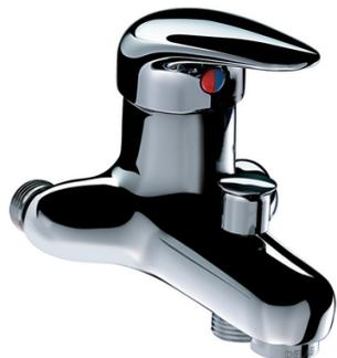
Mitigeur bain-douche universel à cartouche céramique. Corps en laiton chromé. M1/2". Entraxe réglable de 100 à 120 mm. Aérateur antitartre. Inverseur automatique. S'adapte à l'entraxe existant. Permet le remplacement d'un ancien mélangeur par échange standard, sans modification de l'installation.
