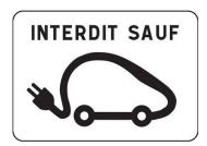
Panonceau routier pouvant être associé au panneau stationnement interdit ou arrêt et stationnement interdit.
