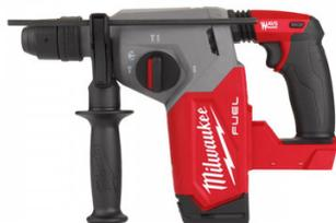
Le perforateur sans fil Milwaukee M18 FHX-0X offre un perçage rapide et des performances maximal, il est équipée d'un mandrin FIXTEC. Compatible avec toute les batteries M18 Redlithium-ion (vendues séparément). Diamètre perçage acier : 13 mm. Diamètre perçage bois : 28 mm. Diamètre perçage béton : 26 mm.
