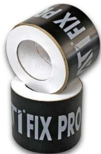
Ruban adhésif haut de gamme imperméable à l'air et à la vapeur d'eau, doté d'un support en polyéthylène (PE), renforcé d'une trame polyester et protégé par un intercalaire en papier siliconé havane. Il est enduit d'un puissant système adhésif acrylique sensible à la pression, conçu pour le jointoiement des films pare-vapeur et pare-pluie.
