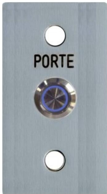
Façade inox avec marquage au laser ?PORTE? équipée d'un bouton poussoir O/33 lumineux bleu. Sortie sur 6 fils longueur 140 mm. 1 contact NO et 1 contact NF indépendants. I maxi : 3A. Fixation : par 2 rivets POP 4 x 8 mm non fournis (2 trous Ø 4,5mm). Découpe (HxL) : 40 x 40 mm et Ø 26 mm
