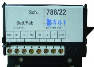
Circuit de taille réduite pour installation dans un poste ou dans certaines plaques de rue. Utilisé pour relayer tout type de sonnerie ou pour relayer une commande d'ouverture de porte ou de portail. 1 contact RT 1A - 24V. Alimentation 12 à 20VCC. Fixation par vis ou par adhésif fournis. Technologie : Open - 2 Fils - 5 Fils
