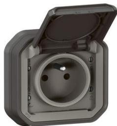
Prise de courant 2P+T 16A 250V - Connexion rapide sans outil avec repérage couleur Produit complet, prêt à être installé sur une boîte d'encastrement à vis IP55 : protégé contre les poussières et les projections d'eau à la lance de toutes directions IK08 : résistance à un choc de 5 joules
