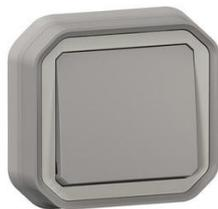
Poussoir NO 10A - Connexion rapide sans outil avec repérage couleur Produit complet, prêt à être installé sur une boîte d'encastrement à vis IP55 : protégé contre les poussières et les projections d'eau à la lance de toutes directions IK08 : résistance à un choc de 5 joules
