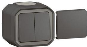
Interrupteur ou va-et-vient 10AX ou poussoir 10A - Connexion rapide sans outil avec repérage couleur. Produit complet, prêt à être installé en saillie - Livré en mode poussoir avec doigt simple monté. IP55 : protégé contre les poussières et les projections d'eau à la lance de toutes directions. IK08 : résistance à un choc de 5 joules.
