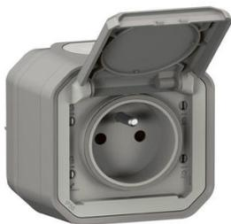
Prise de courant 2P+T 16A 250V - Connexion rapide sans outil avec repérage couleur. Produit complet, prêt à être installé en saillie. IP55 : protégé contre les poussières et les projections d'eau à la lance de toutes directions. IK08 : résistance à un choc de 5 joules.
