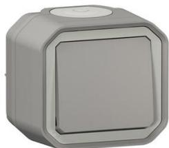
Poussoir NO 10A - Connexion rapide sans outil avec repérage couleur Produit complet, prêt à être installé en saillie IP55 : protégé contre les poussières et les projections d'eau à la lance de toutes directions IK08 : résistance à un choc de 5 joules
