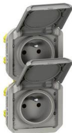
Prise de courant 2P+T 16A 250V - Connexion rapide sans outil avec repérage couleur Produit à compléter soit avec un boîtier saillie, soit avec un support encastré IP55 : protégé contre les poussières et les projections d'eau à la lance de toutes directions IK07 : résistance à un choc de 2 joules
