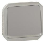
Poussoir NO 10A - Connexion rapide sans outil avec repérage couleur Produit à compléter soit avec un boîtier saillie, soit avec un support encastré IP55 : protégé contre les poussières et les projections d'eau à la lance de toutes directions IK08 : résistance à un choc de 5 joules
